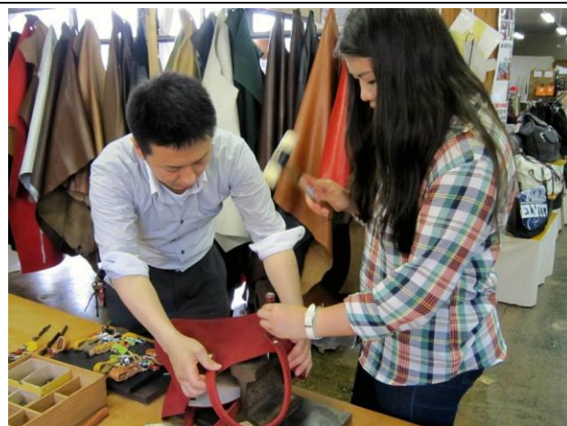
取手を付け仕上げをする。
